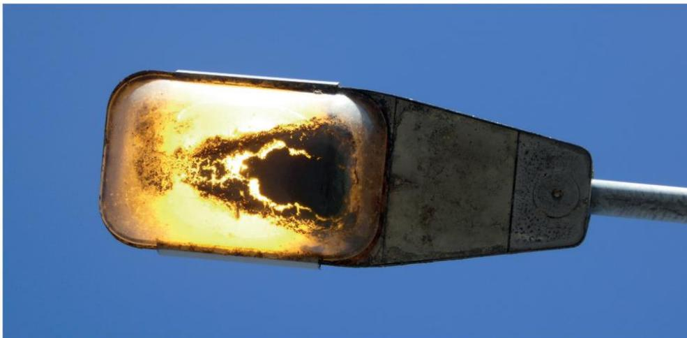
Das Licht der Natriumdampflampen zieht Insekten an. Weil Leuchten mit der Zeit undicht werden, dringen Insekten ein und verbrennen. Dadurch sind die Gläser häufig stark verschmutzt. Folge: Die Leuchtwirkung nimmt ab.
